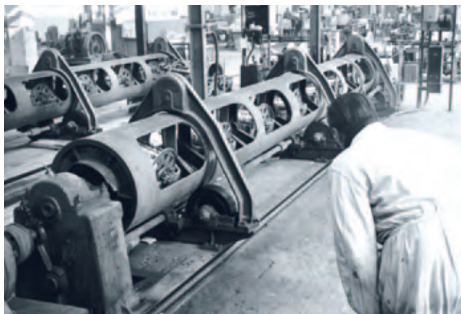
◀ Sección de máquinas para madejar y enrollar cables, Madeco, 1952.
